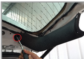
9. Демонтируйте боковые накладки двери багажника
