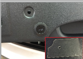
41. Используя шаблон, установите кнопку закрывания двери багажника
