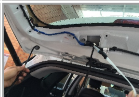
36. Протяните жгут проводов через отверстие как показано на фото
