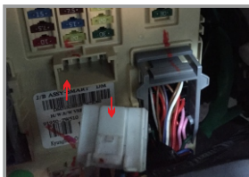
15. Отсоедините оригинальный разъем и подключите разъемы питания основного жгута
