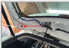
35. Протяните жгут проводов через отверстие как показано на фото
