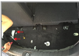
23. Протяните основной жгут в багажник
