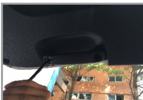
45. Закрутите 2 винта крепления ручки двери багажника
