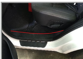
20. Проложите жгут проводки под пластиковой накладкой порога задней левой двери
