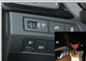
17. Подключите провод ILL из основного жгута проводки к оранжевому проводу
