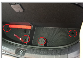
22. Открутите 3 винта крепления поддона багажника и вытащите его
