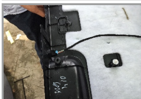
42. Подключите проводку к кнопке закрывания двери багажника
