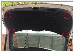
6. Открутите 4 винта крепления обшивки двери багажника
