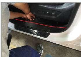
19. Проложите жгут проводки под пластиковой накладкой порога передней левой двери
