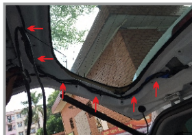
37. Проложите и зафиксируйте хомутами жгут проводов как показано на фото
