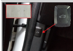
18. Установите кнопку открывания двери багажника на пластиковой накладке
