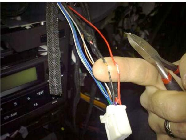
Чтобы убрать штатный экран и работала штатная камера заднего вида нужно объединить красный провод (который идет отдельно и на котором при включении заднего хода появляется питание 12v) с черным проводом (который идет вместе с белым и красными проводами).
