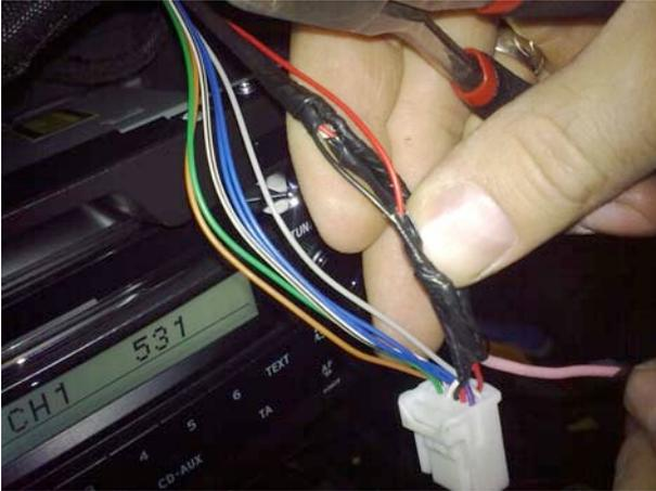
С красного провода который идет отдельно берем сигнал заднего хода и подсоединяем его на провод с надписью ВАСК.
