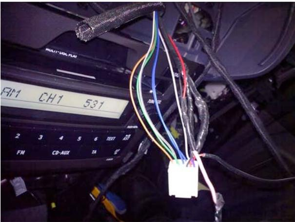
К белому проводу подкусываем экран линейки, а к красному центральную жилу линейки – после чего ее можно подключить в тюльпанный разъем CAMERA.
