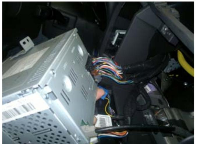
Подключаем штатные разъёмы ГУ к разъёмам Mudean.
