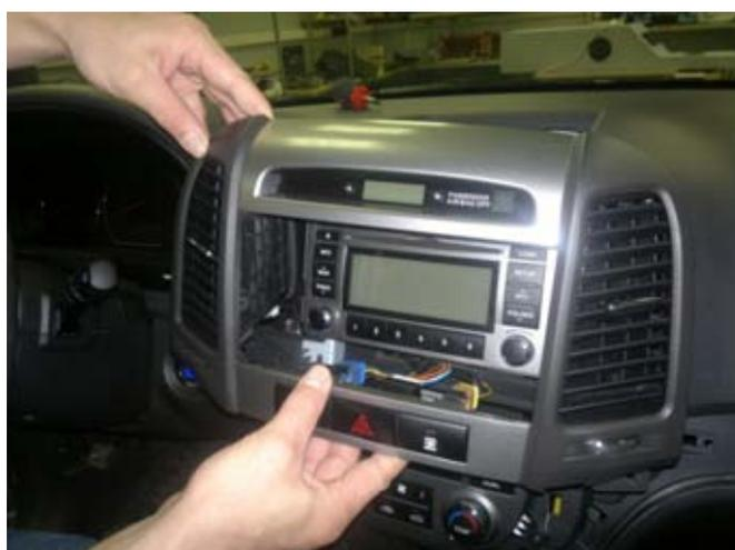
Откручиваем четыре винта крепления ШГУ.
