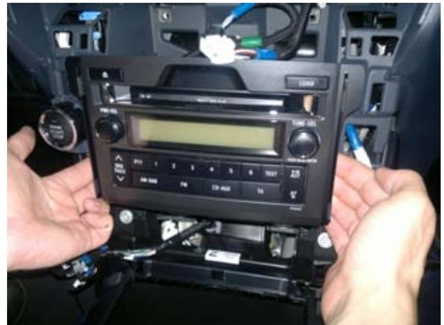
Отсоединяем разъёмы ШГУ
