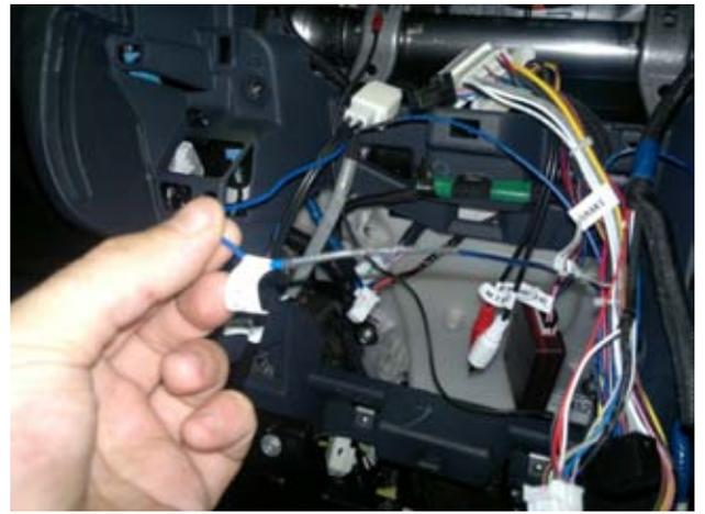
Подключаем штатную камеру заднего вида. Для подключения нужен преобразователь с 12 вольт на 5 вольт. (Красный +12V при включении заднего хода)( Чёрный +5V на камеру )(Белый оплетка видео масса) (Красный видео центральная жила )
