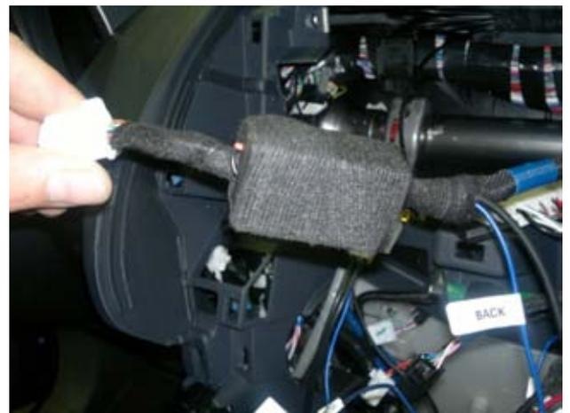
Снимаем верхний козырёк для установки GPS антенны.
