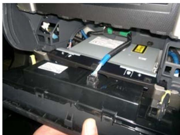
Откручиваем два винта крепления верхней лицевой панели с экраном.
