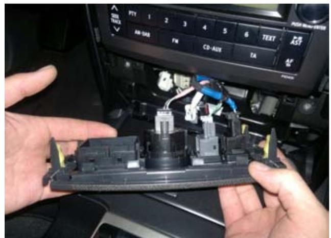
Откручиваем четыре винта крепления ШГУ
