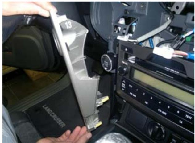
Вынимаем блок кнопок под штатным головным устройством.
