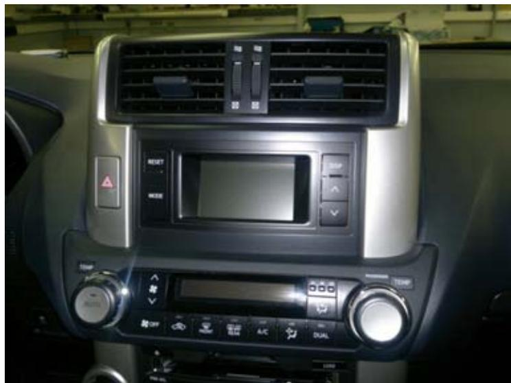
Снимаем блок управления климат контроля.
