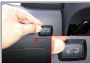
17. Установите кнопку управления электроприводом в салоне и подключите к основному жгуту проводов
