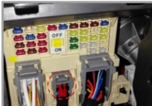
13. Подключите кабель питания к +12В в блоке предохранителей или к АКБ
