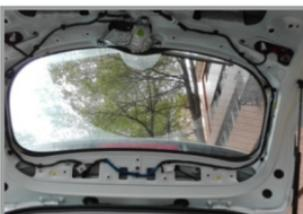
8. Дверь багажника со снятой обшивкой
