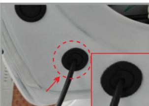
11. Протяните провода от приводов через штатные отверстия в двери багажника
