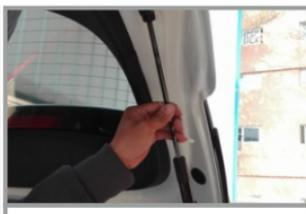
9. Снимите оригинальные газовые упоры двери багажника
