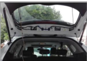
20. Проверьте все разъемы и установите обшивку двери багажника
