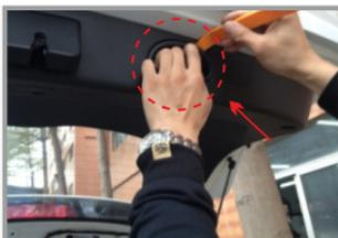
6. Снимите внутреннюю ручку с обшивки двери багажника
