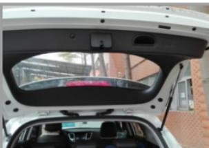
2. Снимите обшивку двери багажника
