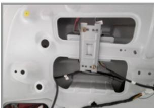
19. Подключите провода к блоку управления, к штатной кнопке и замку багажника
