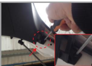
5. Открутите винты крепления обшивки багажника
