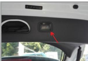
18. Установите кнопку управления электроприводом на обшивку двери багажника
