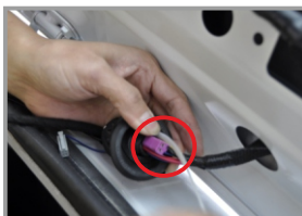
37. Протяните жгут проводов через гофру
