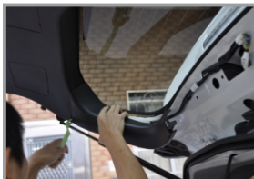
33. Демонтируйте боковые обшивки двери багажника
