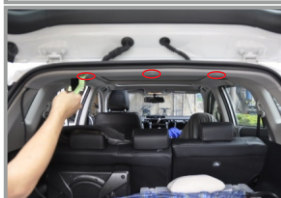
28. Демонтируйте клипсы крепления обшивки багажника
