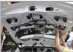
68. Закрепите провода и проверьте работу электропривода
