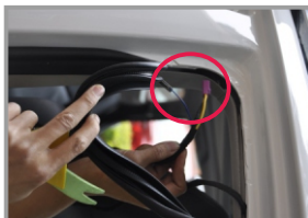
25. Протяните жгут проводов к проему двери багажника
