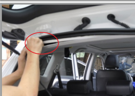
29. Демонтируйте уплотнитель двери багажника
