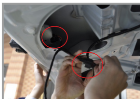
63. Подключите замок багажника и разъем штатной проводки к жгуту проводов электропривода
