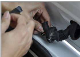
36. Протяните жгут проводов через гофру
