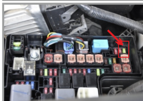
78. Замените штатный предохранитель на новый 25А
