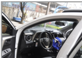
22. Вид после прокладки жгута в проеме водительской двери
