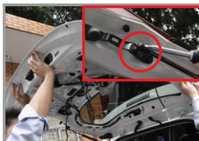
55. Демонтируйте штатные газовые упоры двери багажника
