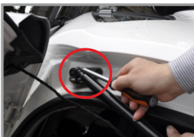
56. Демонтируйте штатные газовые упоры двери багажника
