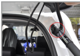
58. Установите электроприводы с кронштейнами из комплекта
