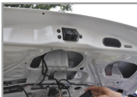
46. Снимите штатную ручку закрытия двери багажника и протяните жгут проводов
