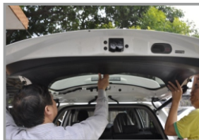
70. Установите обшивку двери багажника
