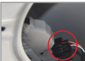
62. Отсоедините разъем штатной проводки от замка багажника
