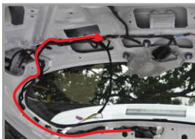
43. Протяните жгут проводов как показано на фото
