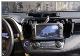
72. Подключите проводку и установите магнитоолу
