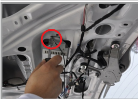
65. Закрепите провод «массы» и установите блок управления на двери багажника
