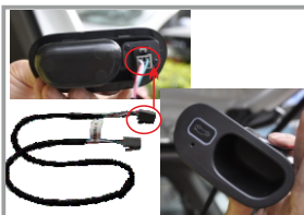
47. Подключите провод к ручке закрывания двери багажника
