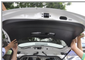
34. Демонтируйте обшивку двери багажника
