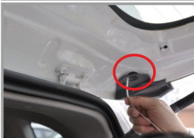
53. Протяните жгут проводов через отверстие
