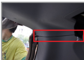
27. Протяните жгут проводов к проему двери багажника
