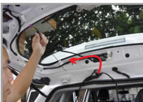
38. Протяните жгут проводов как показано на фото
