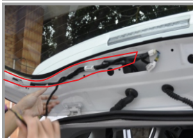
40. Проложите жгут проводов рядом с штатной проводкой
