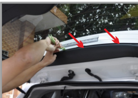
32. Демонтируйте верхнюю часть обшивки двери багажника
