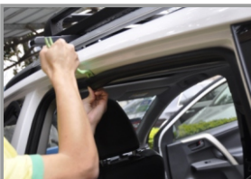
23. Демонтируйте уплотнитель проема левой задней двери
