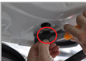
50. Вырежьте отверстие по контуру
