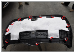
69. Проверьте состояние клипс крепления обшивки
