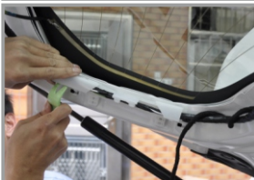
41. Зафиксируйте жгут проводов
