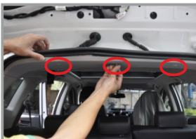
44. Установите клипсы и закрепите обшивку багажника
