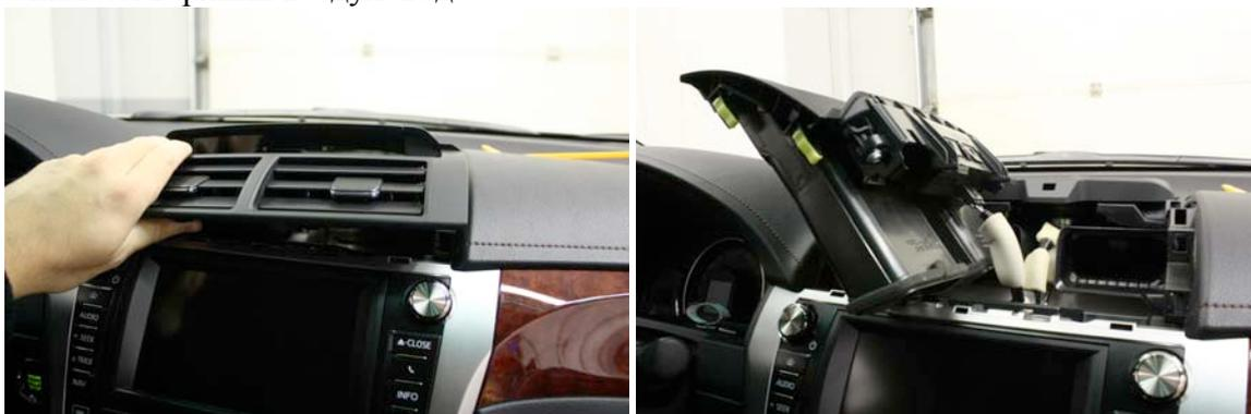
Снимаем нижнюю панель с кнопками обогрева
